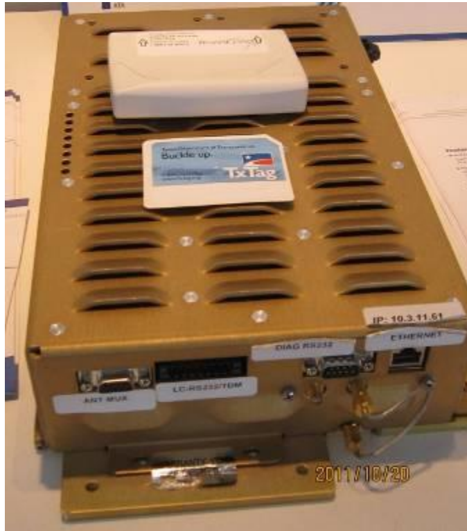
圖 14 Transcore 公司 ETC 之路側終端設備、OBU 及 Tag 由於各州收費系統不一，各有不同之ETC廠商（如 Kapche、Transcore等，皆有相當之準確度），由於跨州旅行的需求，因此就有跨系統整合的需要，如Federal Signal Technologies公司即於現場展示一個自由流之收費設備（號稱可整合五家不同ETC之專業技術），如圖15、16。
